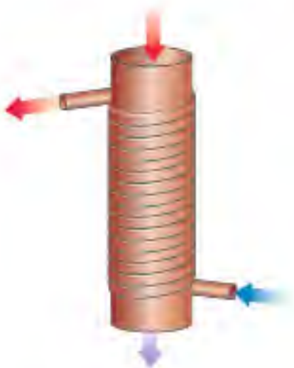
Ovan: Avloppsvärmeväxlare med avloppsröret omlindat med kallvattenröret. Till höger: Avloppsvärmeväxlare med avloppsröret omslutet av inkommande vatten.
